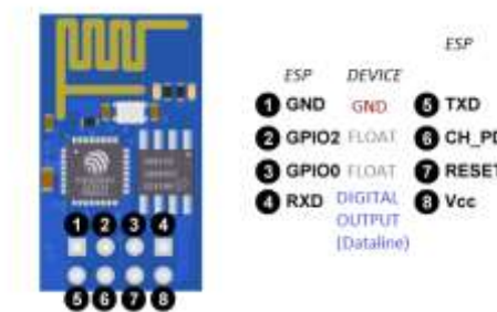
Gambar 2. 4 ESP 8266 (Sumber : www.esp8266.com , 2016)
