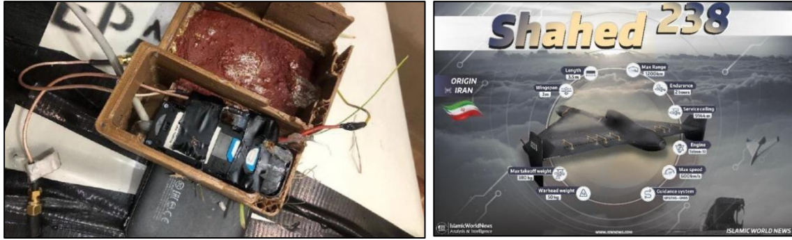
(a) Modem Berisi Kartu Seluler Kyivstar Pada Drone Shaheed (Priezkalns, 2023) (b) Spesifikasi Drone Shaheed (Iswnnews, 2024)
